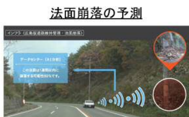
法面崩落の予測 画像解析やセンサー等を活用した崩落の前兆の把握などによる法面崩落の予測
