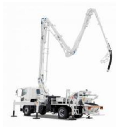
コンクリート ポンプ車
