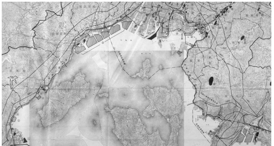
企業立地と工場適地図（広島湾地区）1967（昭和42）年。縦横に伸びているのは送電線で、斜線部は埋立予定地、着色部分は工場適地である。広島から呉に向けて太田川東部工業用水道がほぼ完成している。
