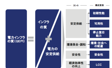
質の高い電力インフラの構成要素 (出典：APECガイドライン)
