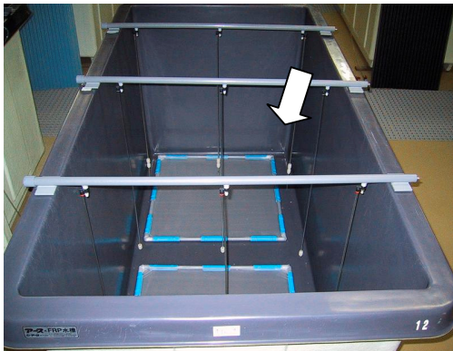
水槽底面に設置したシート
