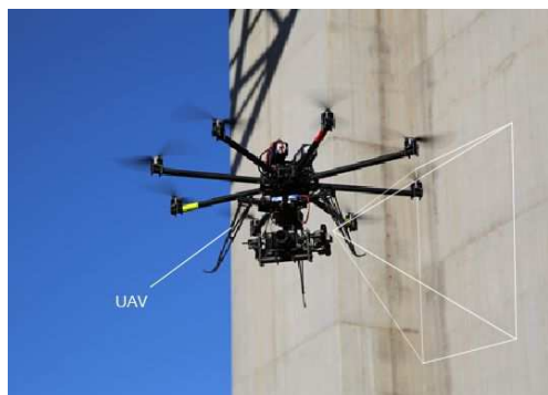
UAVによる施設点検
