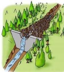
②大雨が降り土石流が発生したとき、堰堤背面に堆積した土砂によって勾配が緩くなることにより、流下する勢いが減少することで大きな岩、流木などを含む土砂のため、下流への被害を防ぎます。(下図赤色部分)
