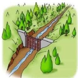
①透過型砂防堰堤を設けた場合でも、普段は水と土砂は同じように下流に流れていきます。
