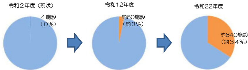
図-2 建設後50年以上の防潮扉(水門・陸閘)数
