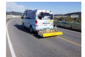
写真-2 床版点検車
