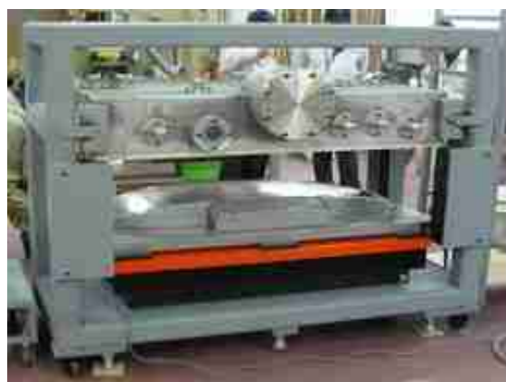
図5 試作したバックドアアウター用の真空チャンバー
