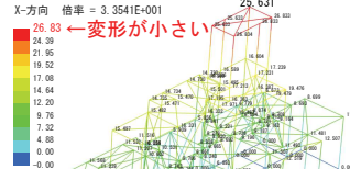
検討案1: ブレース構造/柱口=100x100採用
