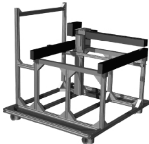
図1 空間磁場自動計測可視化システム (制御部のコンピュータは表示していない)
