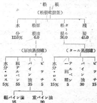
第 1 図 松根油製造工程圖
