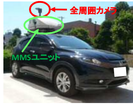
車載レーザ (MMS) を使用して点群データを取得
