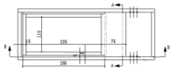
図5 ガラス板を用いた光触媒担持大気浄化装置
