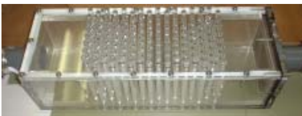
図3 ガラス棒に光触媒を担持させた大気浄化装置
