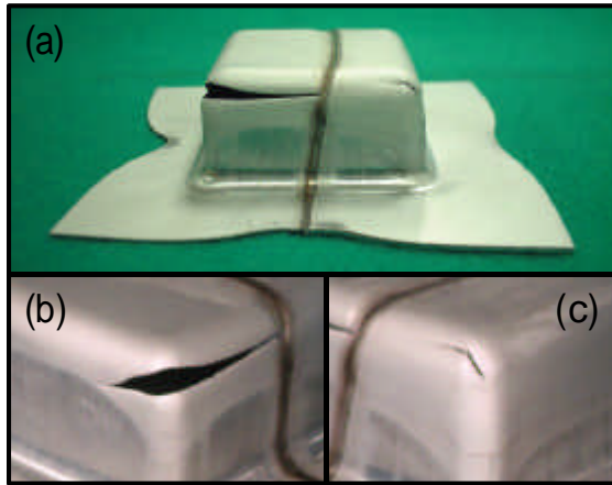
図6 異板厚 TB に発生した破断現象
