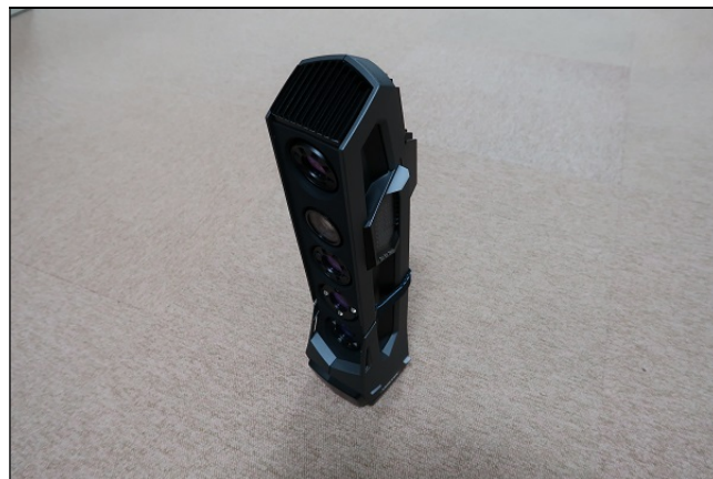
図3 導入した3Dスキャナ (AMETEK社: Go!Scan Spark)
