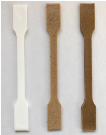
写真1 作製したダンベル試験片 左からおが屑 0, 10, 20 wt%
