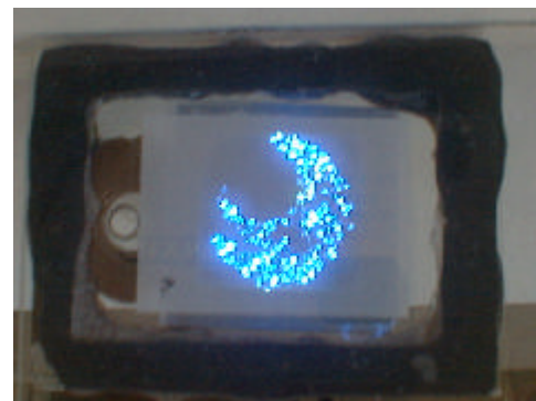
図8 発光中の試作素子 (印加電圧 1500 \text{ V} 電流密度 1 \text{ mA}/\text{cm}^2 )
