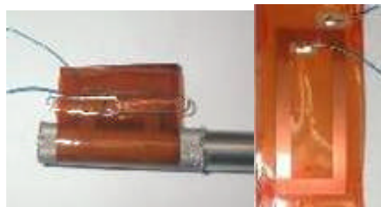
(a)センサー外観 (b)平面コイル部
