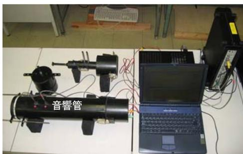
図4 吸音率測定装置
