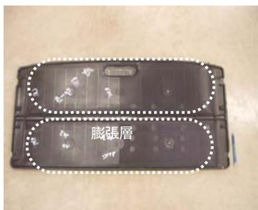
図9 膨張成形による試作ボード
