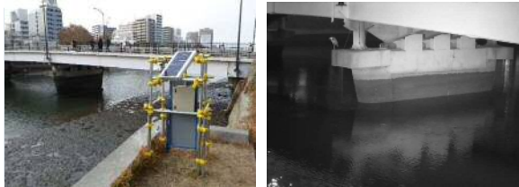
水位観測カメラ実証実験状況 水位観測カメラ解析画像
