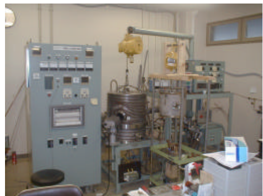
図1 熱フィラメントCVD装置
