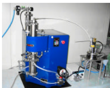
図1 ウルトラアペックスミル UAM015 型
