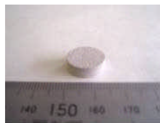
図 6 作製したアルミニウム成形体
