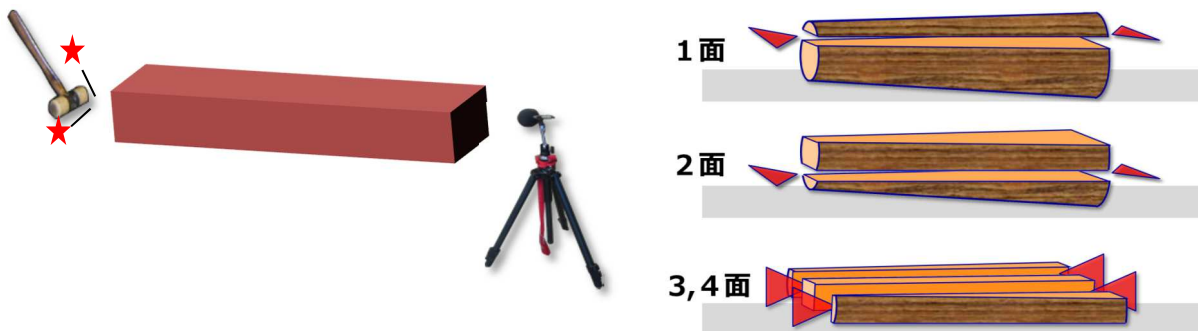
図1 縦振動法の模式図
