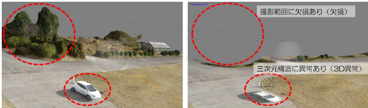
図2 正常な三次元モデル（左写真）と撮影範囲内に異常のある三次元モデル（右写真）
