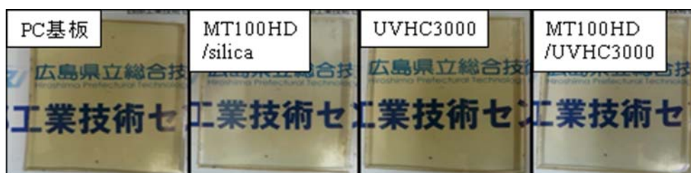
図2 ダイプラ・メタルウェザー試験後のサンプル(168 時間後)
