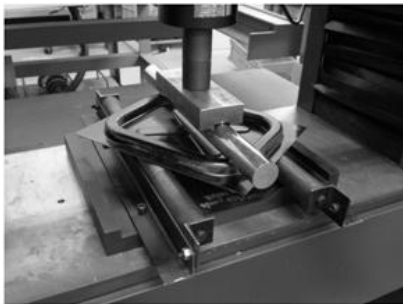
写真1 曲げ試験の様子
