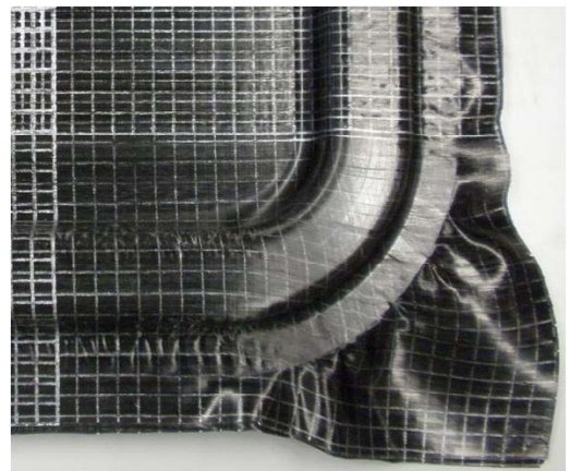
写真2 実成形品 (積層 : [0/90]2s)
