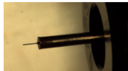
写真2 水平方向加工装置に保持された微細軸の様子
