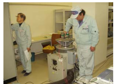
手袋の振動伝達率測定状況
