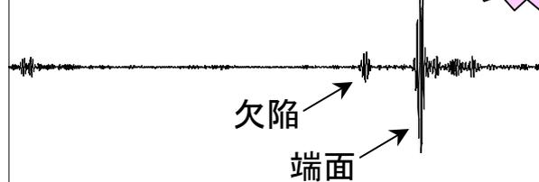
信号処理適用の有無による探傷信号の比較
