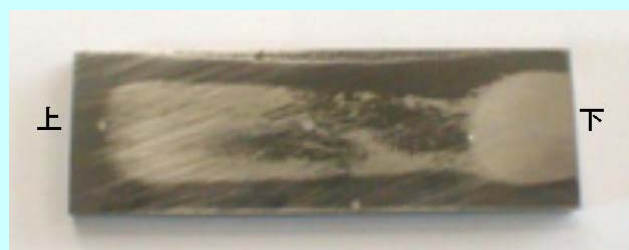
DLC膜の密着性。（サンドペーパーで擦りつけると密着性の違いが現れる）
