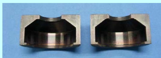
ろう付け治具へのコーティング (DLCはろう材をはじく)
