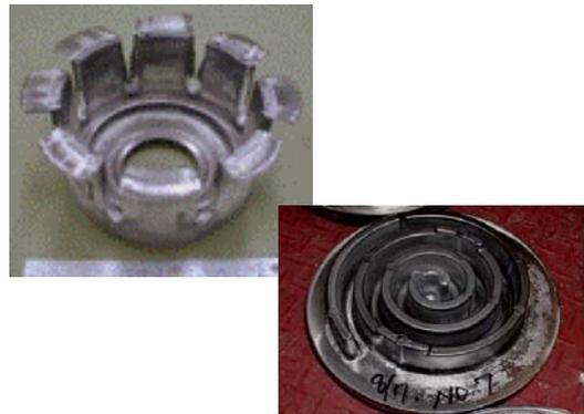
図 試作検討したAl恒温鍛造部品例
