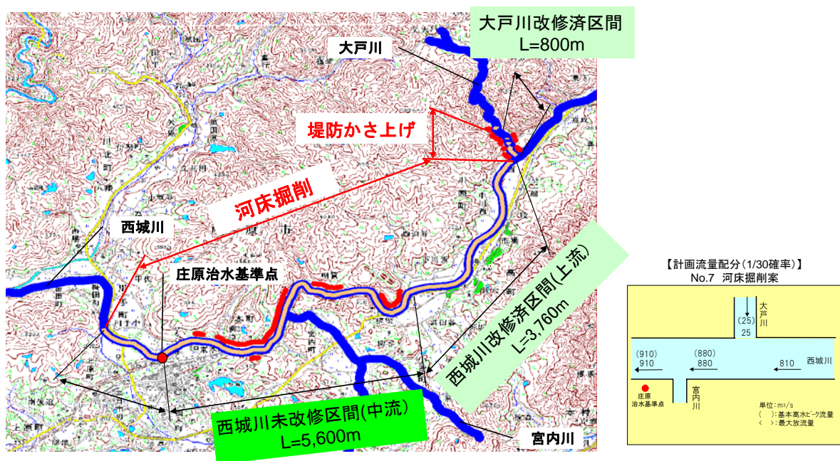
図 3.3.23 No.7 : 河床掘削案
