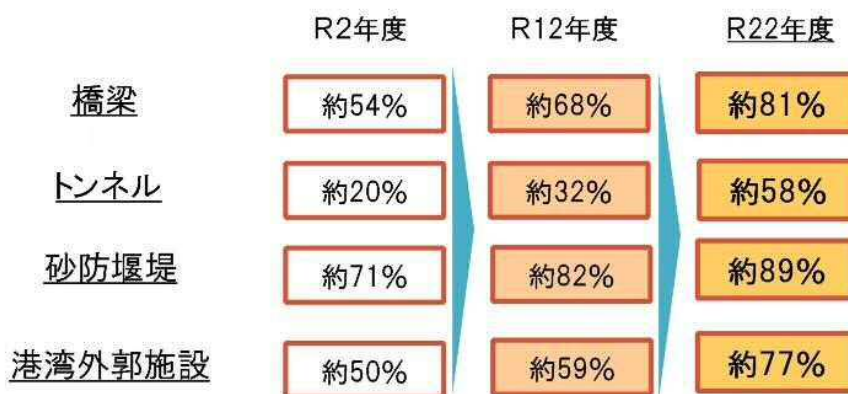
図1.10 建設後50年以上経過する施設の割合
