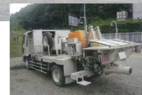
コンクリートポンプ
