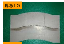
レーザ溶接試験片(曲線形状)
