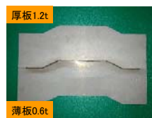
レーザ溶接試験片(直線形状)
