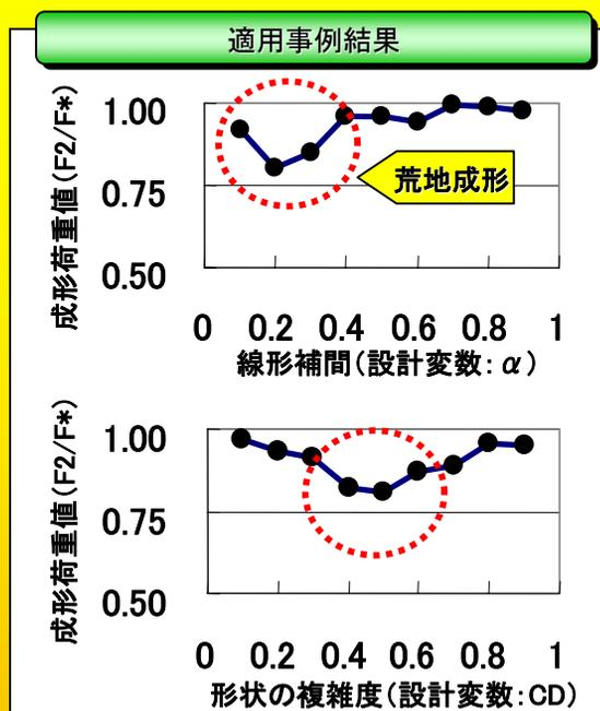
中間金型形状を表す設計変数として、線形補間を用いた場合と形状の複雑度を用いた場合とで最適化を行った例です。線形補間を用いた例では、素材形状に近いところ ( $\alpha=0.2$ ) に好ましい解が存在していました。鍛造成形においては、仕上げ鍛造成形の向上を目的として素材形状を少し成形する『荒地成形』が従来から行われており、本事例はその知見と一致しています。形状の複雑度を用いた例では、素材形状と製品形状の間の複雑度近傍 (CD=0.5) に好ましい解が存在しました。最終的には、これらの結果を基に成形荷重値が最小となる形状が選択されることになります。
