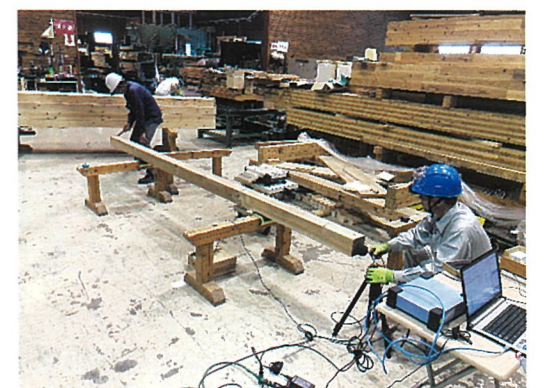
写真2 動的ヤング係数の測定の様子
