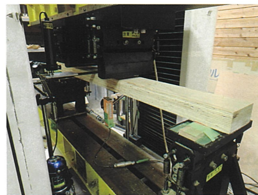
写真2 コウヨウザンLVL曲げ試験
