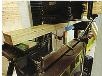
図3 広島県産コウヨウザンLVL曲げ試験
