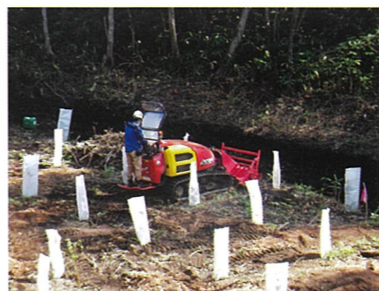
写真3 自走式下刈機走行試験（三次市）
