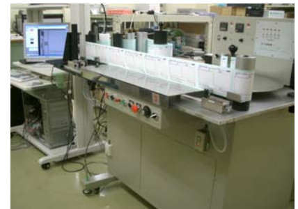
FPGAと欠陥検出アルゴリズムを 応用したラベル印刷の欠陥検査装置
