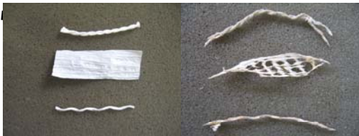
図3 分解前と分解後のネット外観比較
