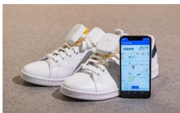
[医療・ヘルスケア] 靴挿入型歩行分析ソリューションシステム
