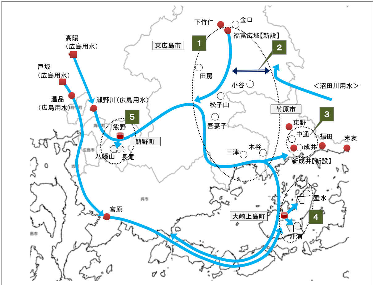
〔凡例〕 ■ 取水場 ● 浄水場 ○ 廃止浄水場 ■ 調整池・配水池 □ 廃止調整池・配水池 ○ 廃止ポンプ所 → 主な送水ルート
