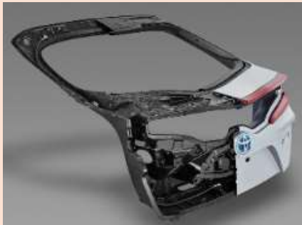
炭素繊維複合材料を使用したトヨタ車のバックドア骨格 (画像提供：トヨタ自動車株)
