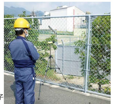
敷地境界の騒音測定の様子
