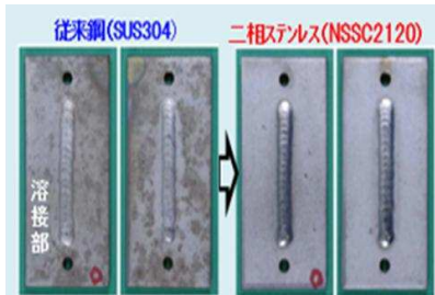
山口県海岸線(海より30m)1年暴露試験結果
