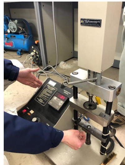
写真 1 材料作成の様子 左：小型押出機 右：小型射出成形機
