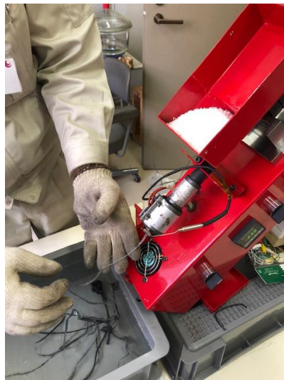
写真 1 材料作成の様子 左：小型押出機 右：小型射出成形機
