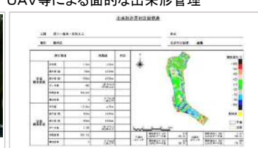
3次元設計データと3次元出来形測量の結果を重ね面的な管理を行う
