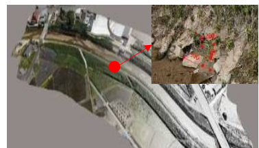
実証実験で撮影したデジカメ画像から 河道3次元モデル作成
